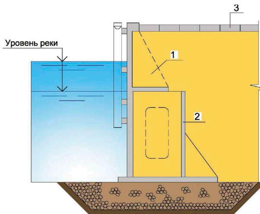
Рисунок 6.5.1 - Конструкция причального сооружения из железобетонных массивов-гигантов:
