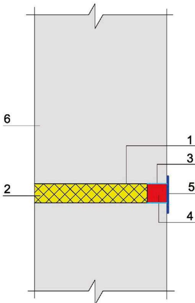
*Рисунок 7.2.57- Гидроизоляция технологических отверстий от стяжек опалубки:*
