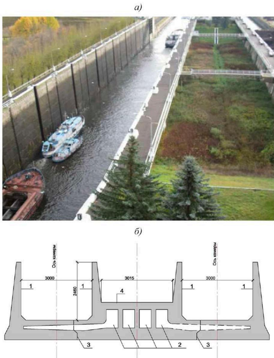
*Рисунок 6.3 - Двухниточный судоходный шлюз:*
