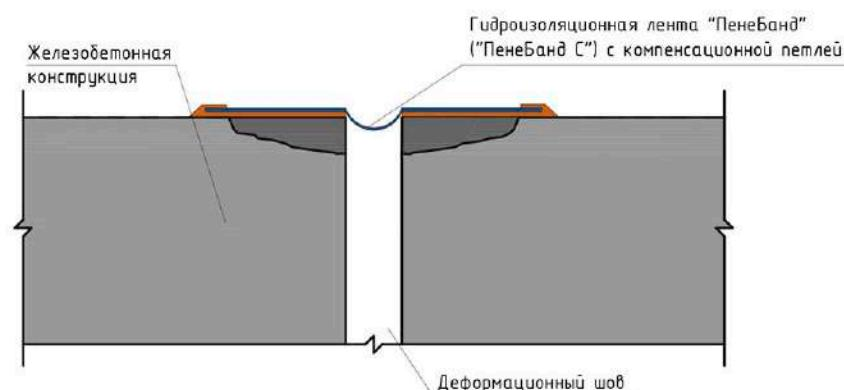
Рисунок 7.3.13 - Монтаж гидроизоляционной ленты «Пенебанд» («Пенебанд С»).
