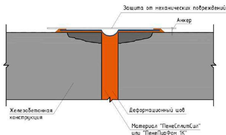
Рисунок 7.3.16 – Защита ленты от механических воздействий.
