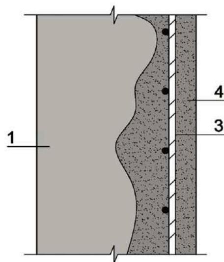
*Рисунок 7.4.5 - Восстановление структурно поврежденного железобетона:*
