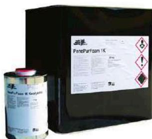
**4.2.12 «ПеноПурФом 1К»** - однокомпонентная, гидроактивная, инъекционная, полиуретановая смола, образующая эластичную пену с закрытой пористостью (технические характеристики см. табл. 4.2.12). При необходимости ускорения полимеризации применяется катализатор «ПеноПурФом 1К Катализатор». Предназначена для остановки напорных течей через швы бетонирования, трещины в бетоне, кирпичной и каменной кладке; долговременной герметизации водонасыщенных подвижных и
