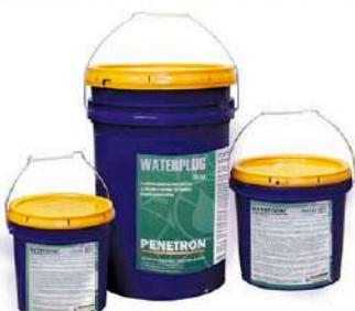
4.2.4 «Ватерплаг» - сухая строительная гидроизоляционная поверхностная смесь, предназначенная для быстрой остановкитечей за счёт расширения при твердении и быстром скватывании. «Ватерплаг» производится согласно ТУ 5745-001-77921756-2006 (технические характеристики см. табл. 4.2.4).
