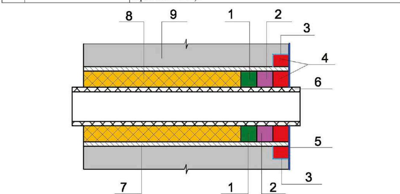
*Рисунок 7.2.52а - Гидроизоляция места ввода коммуникаций:*
