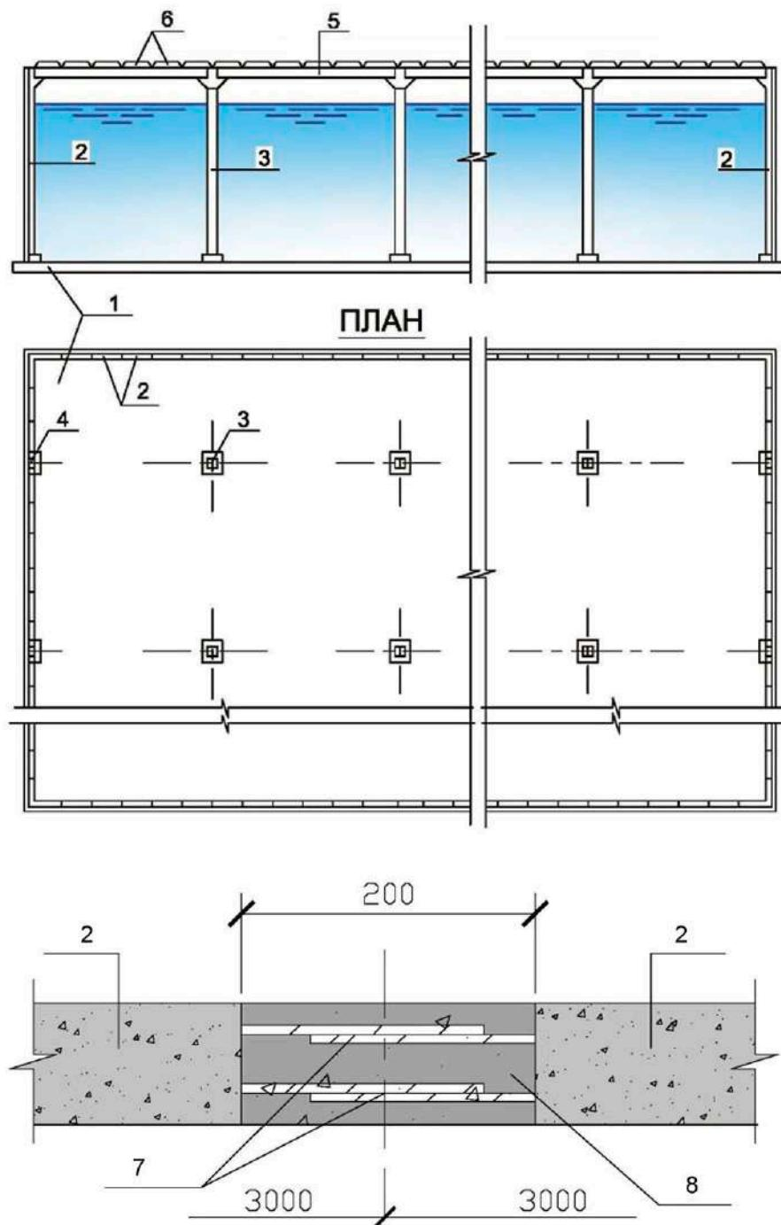
Рисунок 6.4.2 - Схема прямоугольного резервуара из сборных железобетонных панелей:
