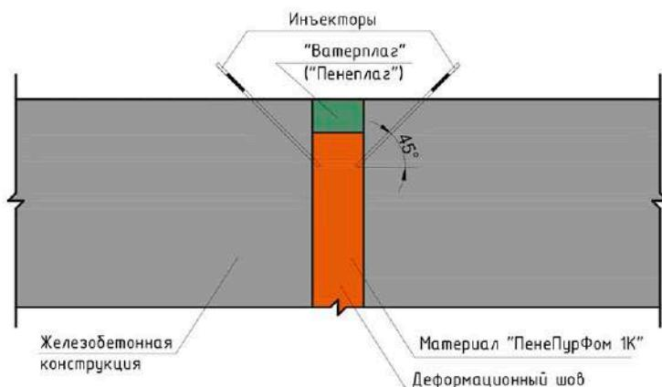
Рисунок 7.3.17 - Устранение течей через полость деформационного шва.
