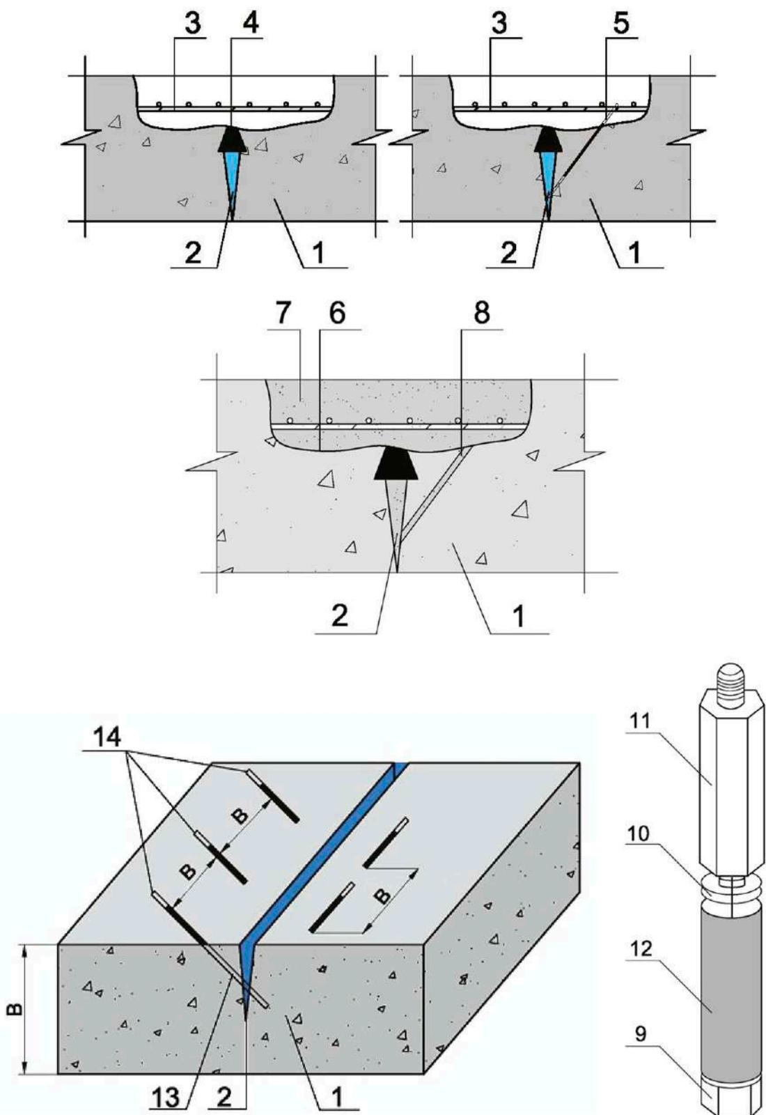
Рисунок 7.4.8 - Заполнение каверн, пустот и полостей в железобетонных конструкциях: 1 - железобетонная конструкция; 2 – водонесущая статичная трещина; 3 – арматура; 4 – гидропломба «Ватерплаг» («Пенеплаг»); 5 – инъектор; 6 – «Пенетрон»; 7 – «Скрепа М500 Ремонтная»; 8 – «Скрепа М600 Инъекционная»; 9 – болт с отверстием; 10 – прижимное кольцо (шайба); 11 – трубка инъектора; 12 – резиновый уплотнитель; 13 – шпур для установки инъектора; 14 – установка инъекторов в шахматном порядке.
