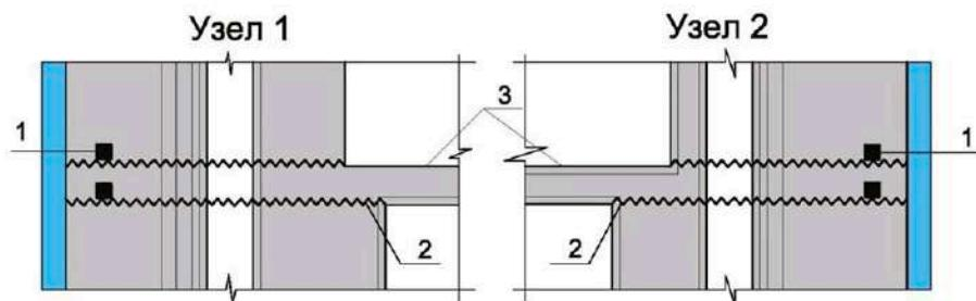
Рисунок 7.1.9 – Типовые узлы гидроизоляции в машинном зале технологических помещений (узлы 1 и 2 на рис. 7.1.8):
