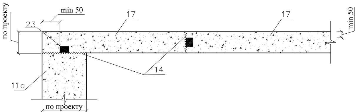
примечание: расстояние от места установки гидропрокладки пенебар до одного из краев конструкции должно быть не менее 50 мм
